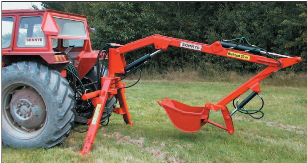
Grävutbyggnad och 50cm skopa monterad på sticka.
